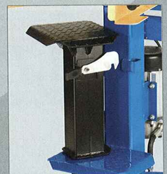
Ausschwenkbarer Zusatztisch mit Tischverriegelung.
